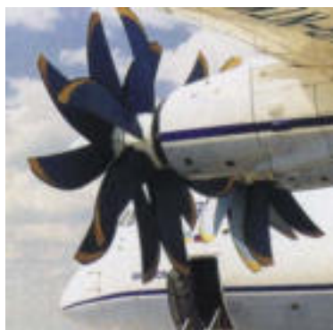
Рис. 2. Эффективный двухрядный пропеллер со встречным вращением лопастей.
