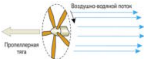
Рис. 8. Использование водяного тумана для повышения тяги винта.
