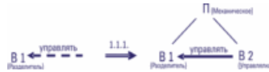
Рис. 10. Достройка неполного веполя до полного.
