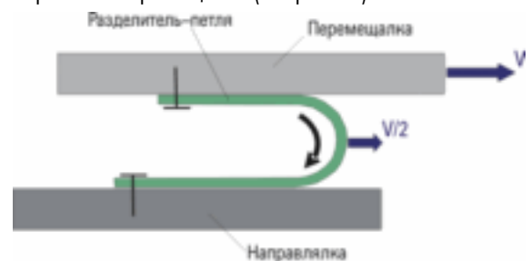
Рис. 13. Разделитель в виде упругой и гибкой перекатывающейся петли.
